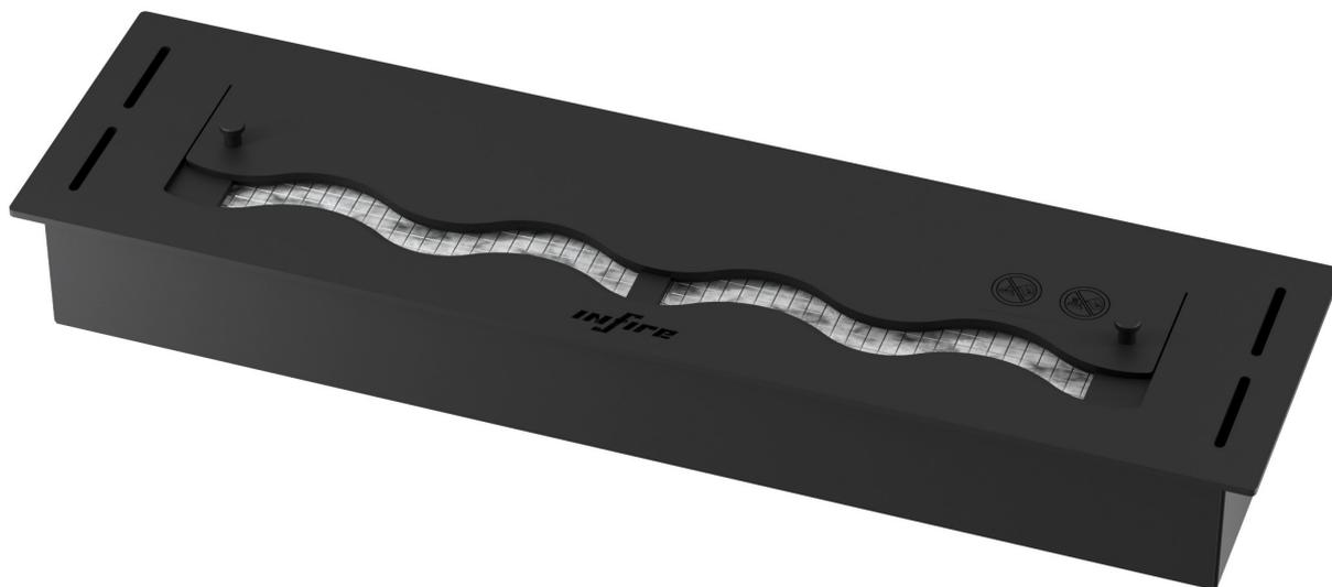
Elegante Bruciatore a bioetanolo in puro acciaio inox con verniciatura nera a polvere resistente alle alte temperature. Regolazione della fiamma tramite apposita manetta. Triplo spessore inox per una durata infinita. Dotato di lana ceramica all'interno per evitare fuoriuscite di liquido. Garanzia 2 anni. Misure: 60x16x7,5
